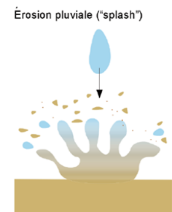
Figure 247 : Schéma de l'effet « splash » (Guide AFB relatif à la protection des milieux aquatiques en phase chantier)
